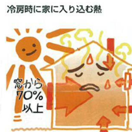
外の熱は屋根、壁、床、開口部などから家の中に入り込む。そのうち、窓から入り込む熱は70%以上を占める
